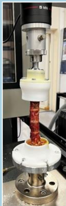
Рис. 3. (а, б) Биомеханические испытания кейджа толщиной 5 мм: а) сегмент позвоночника с установленным кейджем и оснастка в сборке, б) деформационные кривые: 1 – сегмент позвоночника без кейджа, 2) – статическое нагружение сегмента позвоночника с установленным кейджем, 3 – циклические (в диапазоне 20–80 Н) испытания сегмента позвоночника с установленным кейджем, 4 – циклические (в диапазоне 40–120 Н) испытания сегмента позвоночника с установленным кейджем.
